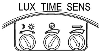
**Внимание: при тестировании в дневное время, пожалуйста включите реле LUX в позицию ☀ (SUN); в противном случае лампа датчика не сможет работать!**
