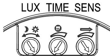
detekuje pohyb a zátížení se zapne do stavu intenzity světla  $<3\text{LX}$  (noční podmínky, po setmění).
