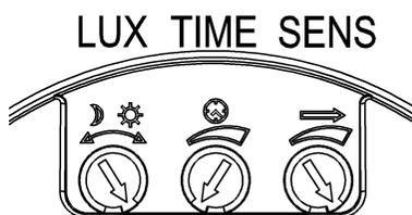
**UWAGA:** podczas testowania urządzenia w warunkach oświetlenia dziennego należy ustawić położenie regulatora LUX w pozycji maksymalnej (SŁOŃCE), w przeciwnym przypadku praca czujnika może być nieprawidłowa!
