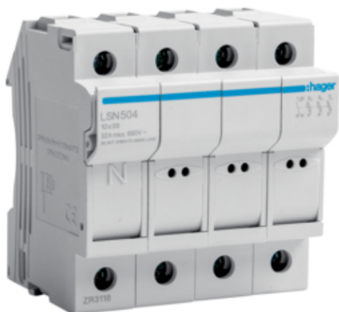
Modułowa podstawa bezpiecznikowa 3P+N wkł.bezp.cyl.L38 10x38mm, 32A 690VAC
