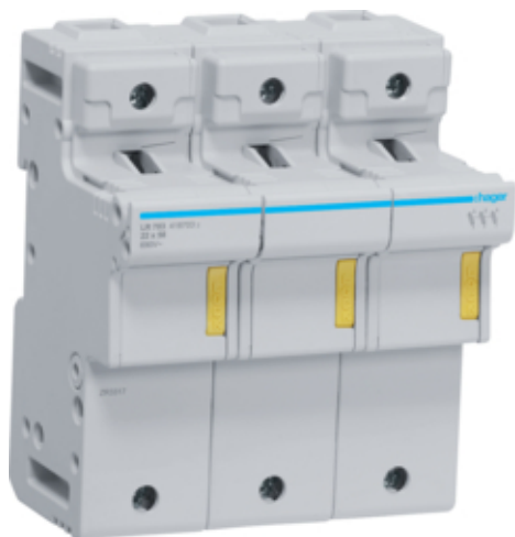
Modułowa podstawa bezpiecznikowa 3P wkł.bezp.cyl.L58 22x58mm 125A 690VAC
