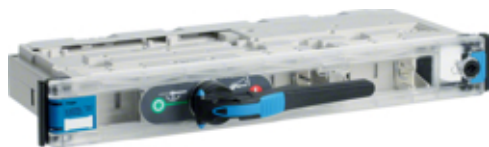
LLD-1 rozł. izol. z bezp. 3P 250A 400VAC odp.prawy AC22B
