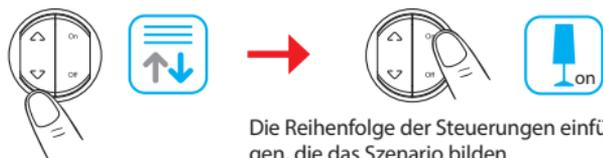
Die Reihenfolge der Steuerungen einfügen, die das Szenario bilden.
