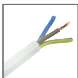
przewód o izolacji polwinilowej (H05VV-F) 3x1.0mm 2
