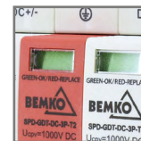
kontrolka stanu ochronnika zielona – wkładka sprawna czerwona – do wymiany
