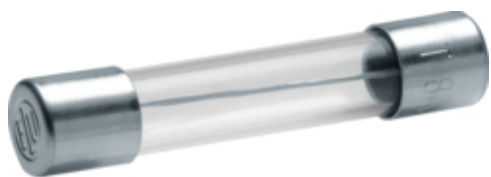
Wkładka bezpiecznikowa szklana T wyk.zwłoczne 6,3x32mm 8A 250 VAC
