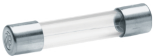
Wkładka bezpiecznikowa szklana T wyk.zwłoczne 6,3x32mm 1,6A 250 VAC
