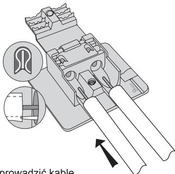
3. Wprowadzić kable antenowe do zacisków tak, aby ostrze zacisku weszło pomiędzy opłot a izolację wewnętrzną. Należy sprawdzić poprawność wprowadzenia przewodu wewnętrznego do zacisku.
