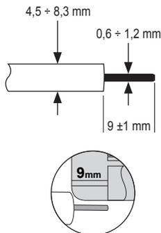
1. Przygotować końcówki kabli koncentrycznych do podłączenia - odizolować przewody wewnętrzne odcinając na tej samej wysokości izolację zewnętrzną, ekran (oplot) oraz izolację wewnętrzną - według znacznika na korpusie.
