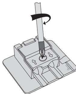
2. Odkręcić śrubę dociskową. Podłączając kable zwrócić uwagę na kierunki strzałek na pokrywie oznaczające odpowiednio zaciski: wejściowy i wyjściowy (\*).
