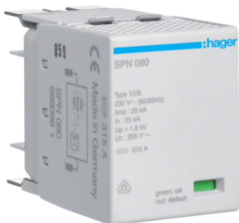
SPD Moduł wymienny T1 kombinowany 1P sieć TN-S/TN-C/TT(L-N) Iimp=25kA Up1,5kV
