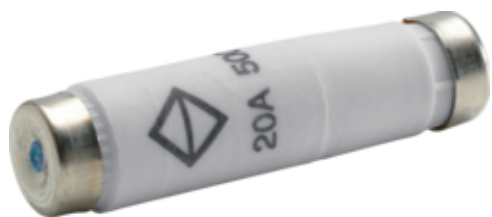
Wkładka bezpiecznikowa NDZ DI/E16 wyk.zwłoczne gG 20A 500VAC
