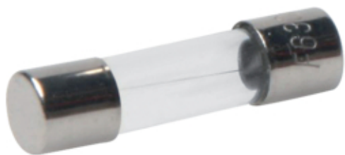
Wkładka bezpiecznikowa szklana T wyk.zwłoczne 5x20mm 0,032A 250VAC
