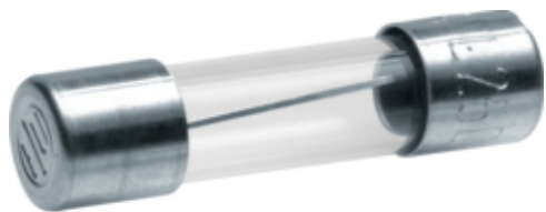
Wkładka bezpiecznikowa szklana F wyk. szybkie 5x20mm 10A 250VAC
