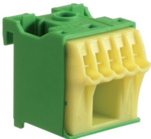
QuickConnect Blok samozacisków ochronny, zielony, 1x16+5x4mm 2 , szer. 30mm
