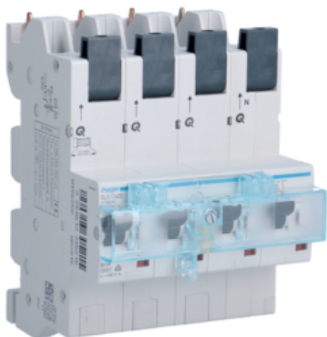
MCB SLS Wyłącznik nadprądowy selektywny 3P+N, Cs, 25 A, szyny Cu 40-12x5/10mm
