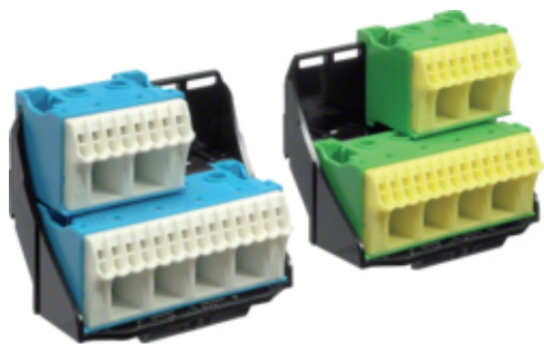
Bloki zaciskowe PE/N na wsporn. 2x28otw. (6x16mm222x4mm2) QuickConnect (2szt.)
