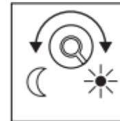
Die gewünschte Ansprechschwelle der Leuchte kann stufenlos von ca. 3–2000 Lux eingestellt werden. Einstellregler Linksanschlag bedeutet Dämmerungsbetrieb ca. 3 Lux. Einstellregler Rechtsanschlag bedeutet Tageslichtbetrieb ca. 2000 Lux. (Bei Auslieferung ist die Leuchte werkseitig auf Tageslichtbetrieb eingestellt.) Bei der Einstellung des Erfassungsbereiches und für den Funktionstest bei Tageslicht muss der Einstellregler auf Rechtsanschlag stehen.
