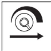
Mit dem Begriff Reichweite ist der etwa kreisförmige Durchmesser auf dem Boden gemeint, der sich bei Montage in 2,5 m Höhe als Erfassungsbereich ergibt. Reichweiteneinstellung Linksanschlag bedeutet minimale Reichweite ca. Ø 1 m,
