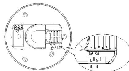
Poniżej przedstawiony jest schemat podłączenia czujnika alarmu oraz oprawy bez czujnika ruchu:
