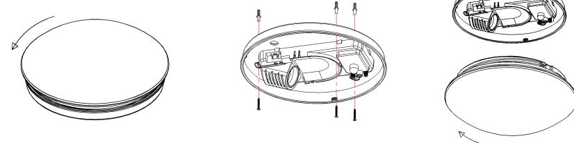
Im Zweifel müssen Sie die Kabel mit einem Spannungsprüfer identifizieren; anschließend wieder spannungsfrei schalten. Phase (L) und Neutralleiter (N) werden an der Lüsterklemme angeschlossen. PE-Schutzleiter, falls vorhanden, mit Klebeband isolieren.
