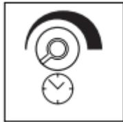
Die gewünschte Leuchtdauer der Leuchte kann stufenlos von ca. 5 Sek. (Einstellregler Linksanschlag) bis max. 12 Min. (Einstellregler Rechtsanschlag) eingestellt werden.
